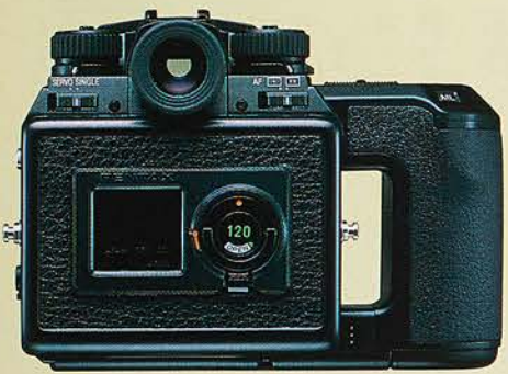
●ボディ背面 ファインダーの左右にあるAFモード切り替えレバーとAFエリア切り替えレバーは、撮影中に親指で操作可能。グリップ右上のメモリーロックボタンで露出値の記憶ができる。
