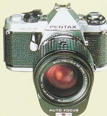
ペンタックスM F (1981年) 世界最初のTTLオートフォーカス一眼レフ。MEスーパーを土台に、MOS型イメージセンサーをカメラ底部に入れたコンラストラ方式のAF機。AFレンズとボディマウント部に、AF用の接点が新設されている。
