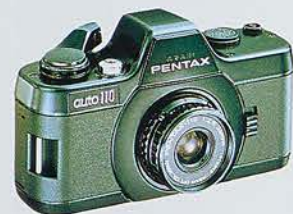
アサヒペンタックスAUTO 110 (1980年) 110サイズフィルムカートリッジカメラを一眼レフ化した製品。本格的なオートドライブも装着可能な派であった。電子制御プログラムシャッターや、SPD受光素子を用いたTTL中央重点平均測光式プログラムAEを採用。
