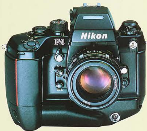
ニコンF4s(1988年) 単3乾電池6本を収納するハイパワーバッテリーパックMB-21を標準搭載。最高約5コマ/秒の連続撮影が可能。また、このバッテリーパックにはLEDによるバッテリーチェックや縦位置リリーズボタン、リモートコードが使えるリモートコネクタなどを装備している。
