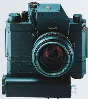
フォトミックFTN NASA仕様(1972年) NASAとの契約でニコンカメラが製作したスペースカメラ。スカイラブ計画で使用された。フォトミックFTNをベースに耐久性や精度、材質など、あらゆる面で見直しが行われている。レンズの突起とノブ式の巻き戻しは手袋をはめていても操作しやすくなるため。
